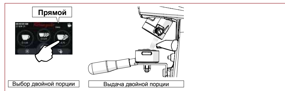
Рис. 13 - Выдача двойной порции в «Прямом» режиме.
