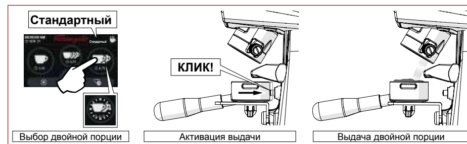
Рис. 12 - Выдача двойной порции в «Стандартном» режиме.
